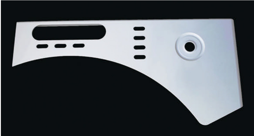
Die geschäumte Waschmaschinenblende, hier ein Prototyp von Miele, ist laut Hersteller 35 % leichter als ein herkömmliches kompaktes Teil. Zur Gewichtseinsparung wegen der Schaumstruktur kommt – Stichwort Gestaltleichtbau – das schlankere Bauteildesign (Bild: Trexel)
