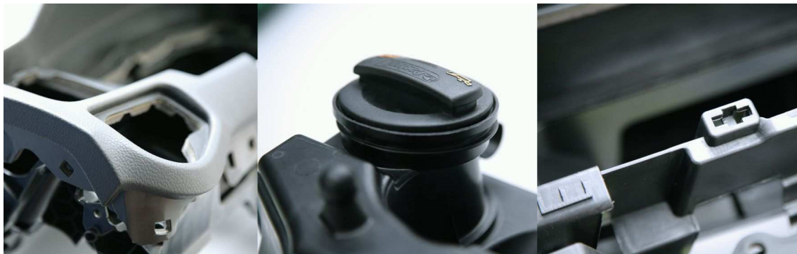
Bis zu 20 Prozent leichter sind mittels MuCell hergestellte Bauteile im Vergleich zu klassisch spritzgegossenen Komponenten. Zudem eröffnet das Schaumspritzgießen den Produktdesignern neue Freiheitsgrade.
