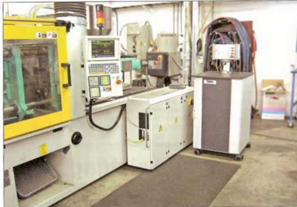
Sowohl Arburg (im Bild) als auch Engel bieten das SCF-III-MuCell-System als Option für ihre kleineren Spritzgießmaschinen an
