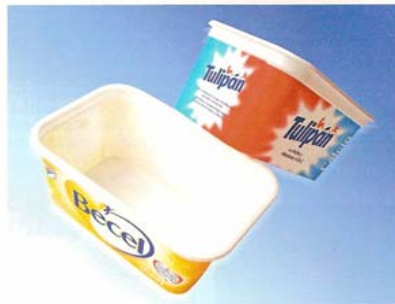
Unter der Bezeichnung SLIM (für Super Light Injection Moulding) vermarktet Autobar seine mit einer Kombination aus MuCell-, IML- und Dünwand-Technik gefertigten Behälter; entsprechende Teile sind am Trexel-Stand zu sehen, deren Herstellung zeigt Netstal auf einer Evos-Hybridmaschine Foto: Netstal
