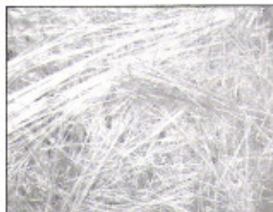
Im Gegensatz zur Verarbeitung mit einer Standard-schnecke (oben) bleibt die Länge der Glasfasern bei Einsatz der LGF-Schnecke (unten) erhalten
