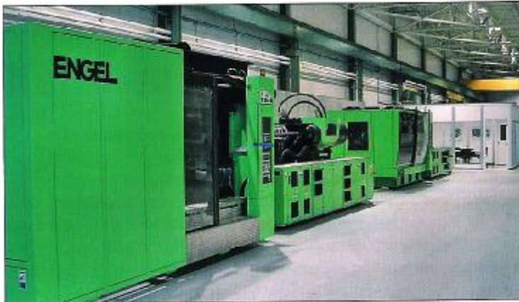
Die 10.000-kN-Zweiplattenmaschine der Baureihe DUO im Engel-Technikum York/USA ist mit einer 120-mm-Schnecke der neuen Geometrie ausgerüstet und steht für Versuche zur Mucell-Verarbeitung langglasfasergefüllter Kunststoffe zur Verfügung
