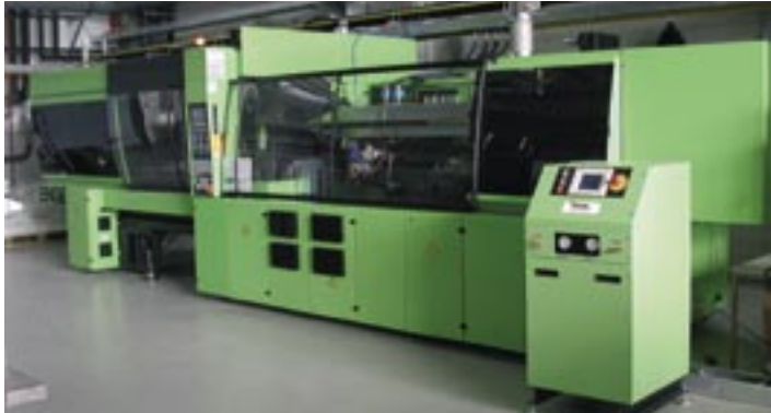
Neue Materialien Bayreuth GmbH verwendet zur Untersuchung des physikalischen Schäumprozesses eine Spritzgieß-Maschine vom Typ Engel ES 1800/250HL mit MuCell-Technologie.
